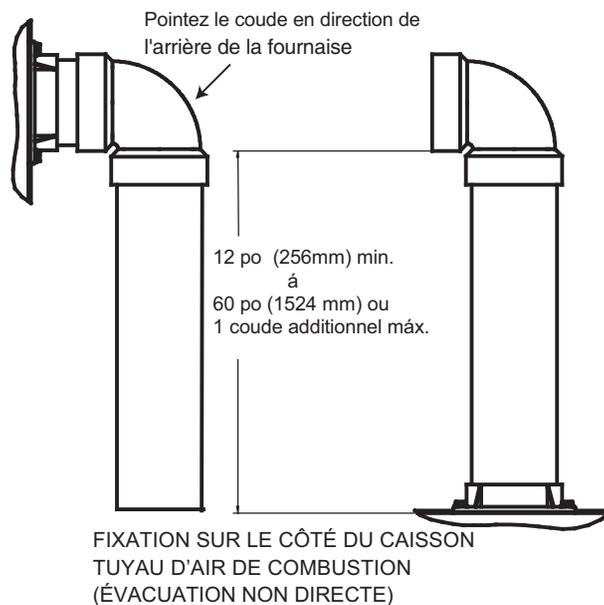
Fig. 44 - Fixation de la conduite d'air de combustion
