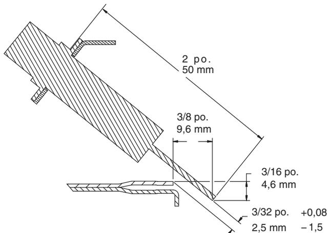
Fig. 58 - Position de l'allumeur - vue de côté
