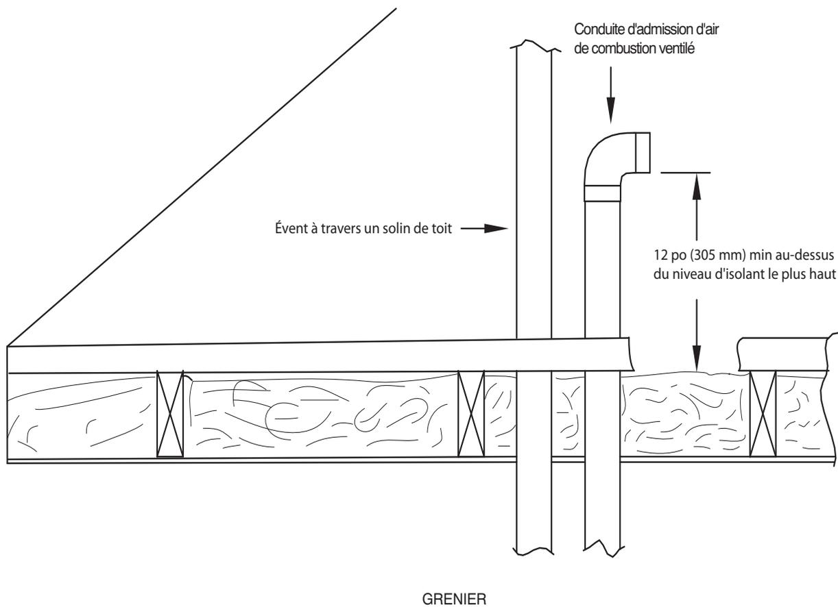
Fig. 50 - Sorties d'évent pour air de combustion ventilé
