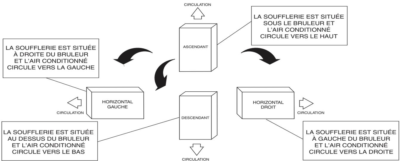
**Fig. 2 - Orientations à configuration multiple**
