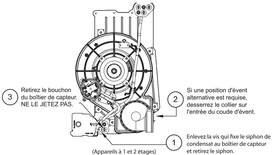
Configuration non convertie en usine telle que vue dans l'orientation horizontale de droite
