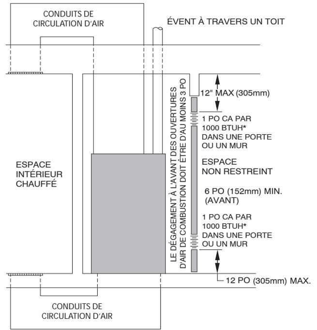
\* La dimension minimum de l'ouverture est de 100 po ca (64 516 mm ca) avec dimensions minimum de 3 po (76 mm)
