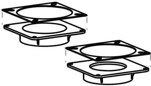
Placer les joints d'étanchéité sur les adaptateurs des tuyaux d'évacuation et d'air de combustion.
