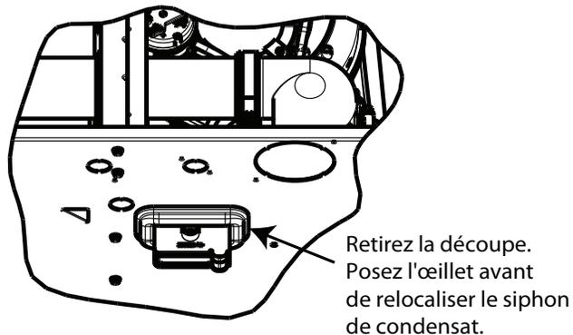
**Fig. 16 - Œillet du siphon de condensat horizontal**
