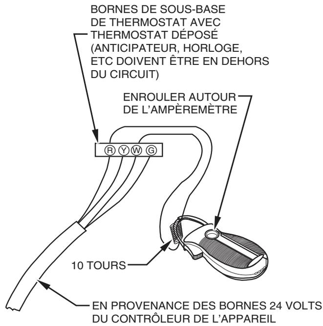
EXEMPLE :  $\frac{5,0 \text{ AMPS SUR L'AMPÈREMÈTRE}}{10 \text{ TOURS AUTOUR DES MÂCHOIRES}} = 0,5 \text{ AMPÈRES POUR LE RÉGLAGE DE L'ANTICIPATEUR DU THERMOSTAT}$
