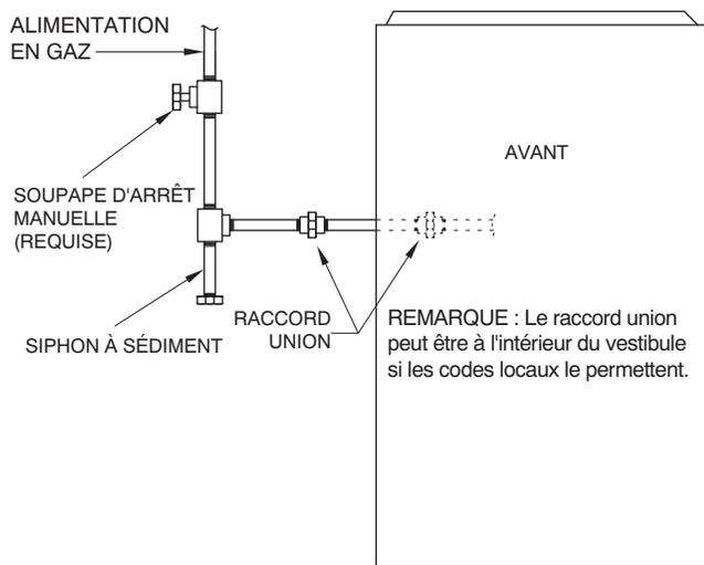
Fig. 30 - Disposition type de la tuyauterie de gaz
